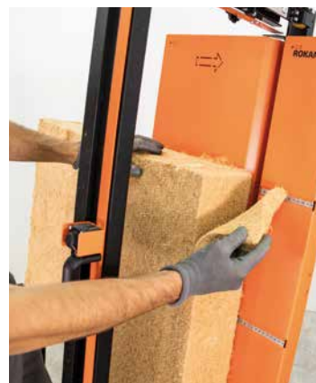
Auch für Holzfaserdämmplatten geeignet (Sonderzubehör)
